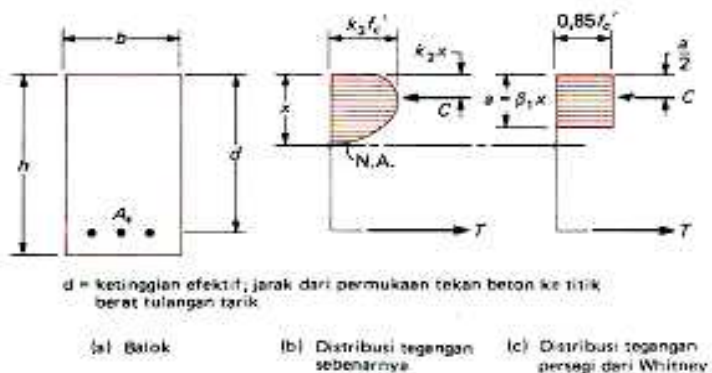
Gambar 2. Distribusi tegangan regangan balok beton bertulang
