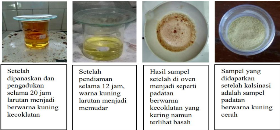
Gambar 4.3 Tahapan sintesis bismut oksida menggunakan metode sol gel
